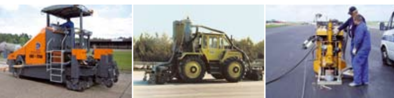
«POSSEHL» Техника для шлифовки и улучшения шероховатости покрытий, техника для нарезки канавок и для бурения кернов
