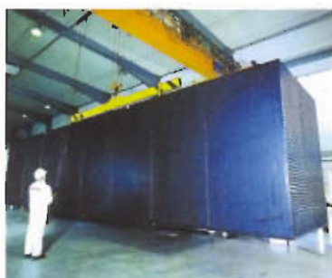
Ванна – Беккалост объемом 100м³ для быстрого санирования установки для травления.
