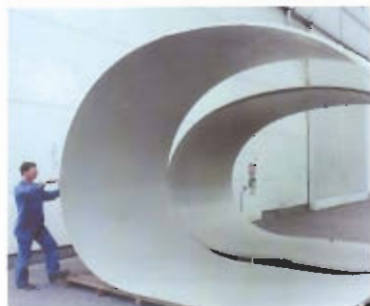
Подготовленная емкость для монтажа в труднодоступных зонах установки.
