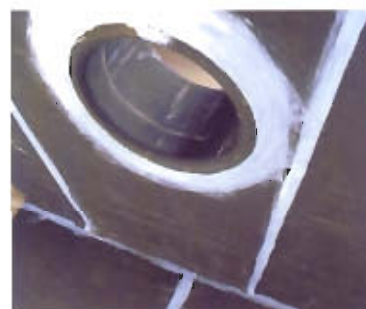
Гуммирование детали углеродной трубы, с дальнейшей футеровкой углеродистым кирпичом.
