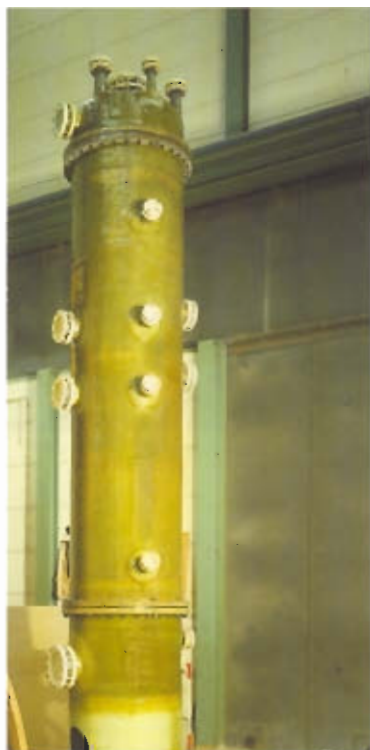
Емкость под давлением из полипропилена, армированная стекловолокном.
