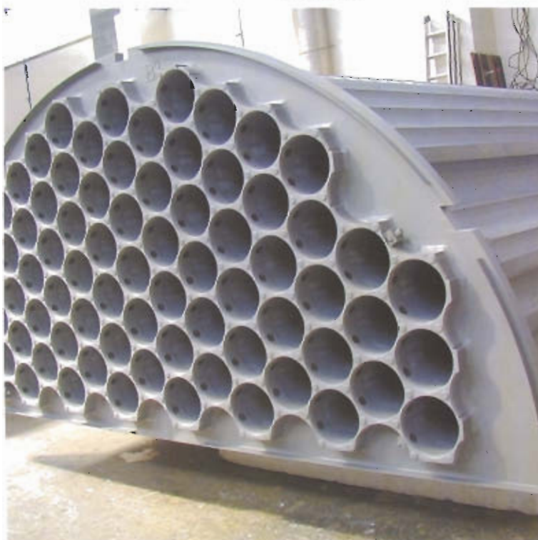
Пучок труб для микро электрофильтра из огнестойкого полипропилена.
