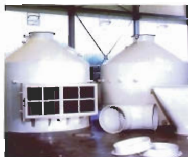
Аэрозольный сепаратор, трубопроводы и встроенные детали, изготовленные из полипропилена.
