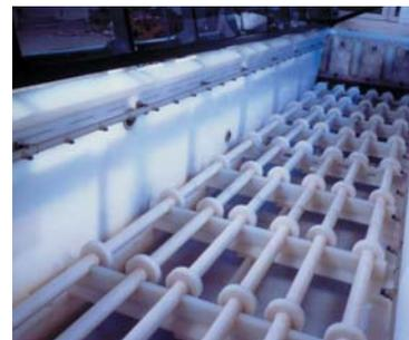
Für Flusssäurebeanspruchung ausgelegter Polypropylenbehälter mit Polyvinylidenfluorid-Einbauten.
