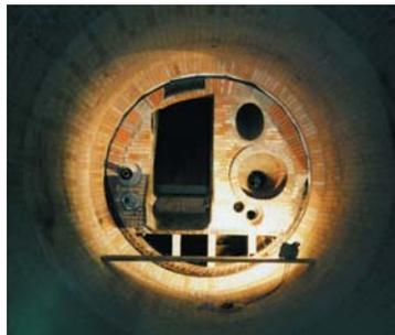
Drehtrommel einer Rückstandsverbrennungsanlage mit Blick auf die Stirnwand, komplett gemauerte Ausführung.
