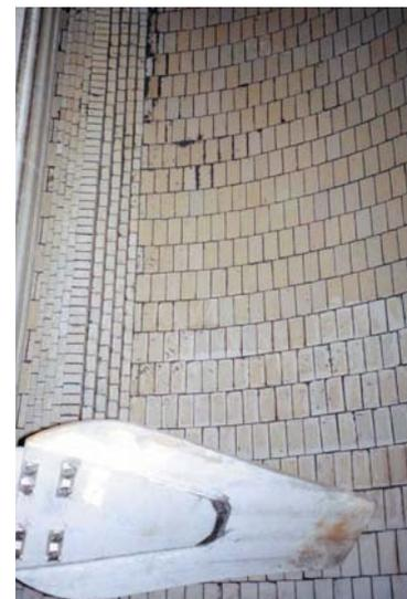
Ausgemauerter Rührwerksbehälter mit Wellenbrecher.
