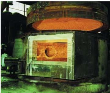
Feuerfeste Auskleidung eines Aluminium-Schmelzofens.
