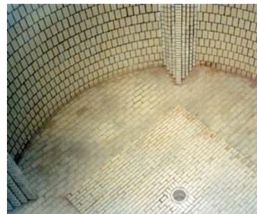
Beschichteter Reaktor mit zusätzlichem keramischem Verschleißschutz und Wellenbrechern.
