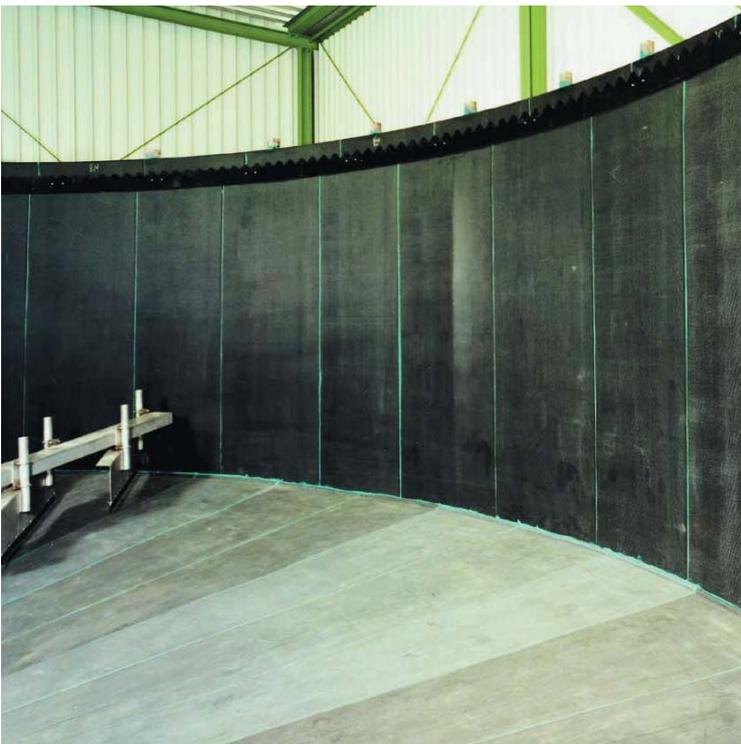
Gummiertes Rührwerksbehälter in der Chemieproduktion. Auch Überlaufrinnen und die gesamte Tragkonstruktion wurden gummiert.
