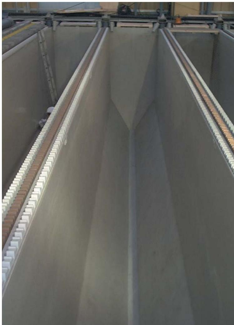
Installierte Elektrolysezellen mit mechanisch verankerter Thermoplastauskleidung, Auflageleisten für Anoden und Kathoden.
