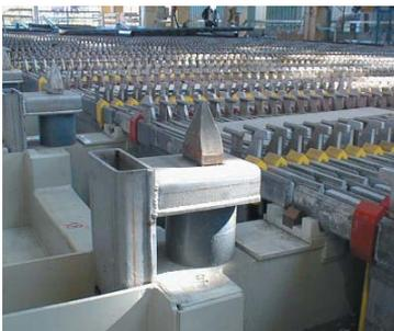
Überlaufkästen, Kransteuerungspunkte, Auflageleisten und Rohrleitungen aus Polypropylen.
