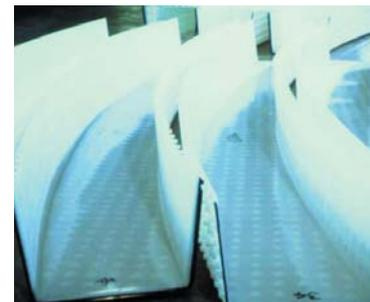
Im Werk vorgefertigte Thermoplastrienen System Bekoplast™ für den Einsatz in der Elektrolytaufbereitung.
