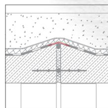
Изделия ряда ASO-Dichtband-2000 состоят из материалов нового поколения: сополимеров полипропилена и полиуретана и обладают высокой устойчивостью к щелочной среде. Кроме того, они устойчивы к маслам и жирам. Высыхание склеенных стыков обеспечивается хорошими диффузионными свойствами. Материалы устойчивы к действию микроорганизмов и UV-излучению.
