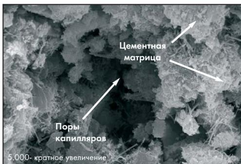
Без **BETOCRETE-C17 (BV)**. Не модифицированный бетон - обычно пористая система, которая допускает проникновение воды.
