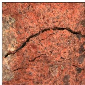
Изображение усадочной трещины в окрашенном красным цветом бетоне (32-кратное увеличение)
