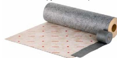
**ADF-Balkonfolie** можно укладывать сразу же после набора необходимой прочности стяжки (примерно 3 – 7 суток) и уже через сутки облицовывать плиткой. Благодаря воздушным каналам нетканого полотна, которые отвечают за распределение пара, отводится находящаяся в стяжке остаточная влажность. Раскрой производится в зависимости от геометрии гидроизолируемой поверхности с помощью ножниц. Из-за отсутствия ячеистой структуры **ADF-Balkonfolie** достигается незначительный расход клеевого раствора.
