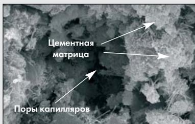
Без ВЕТОСРЕТЕ-С17 (ВВ). Немодифицированный бетон - обычно пористая система, которая допускает проникновение воды.
