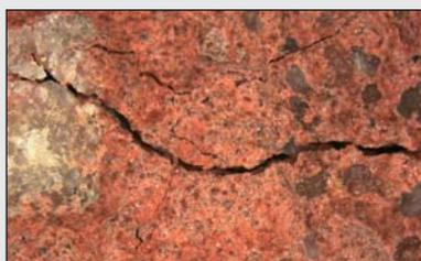
Изображение усадочной трещины в окрашенном красным цветом бетоне (32- кратное увеличение)
