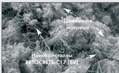
Модифицированный бетон гидроизолируется благодаря появляющимся кристаллическим волокнам.
