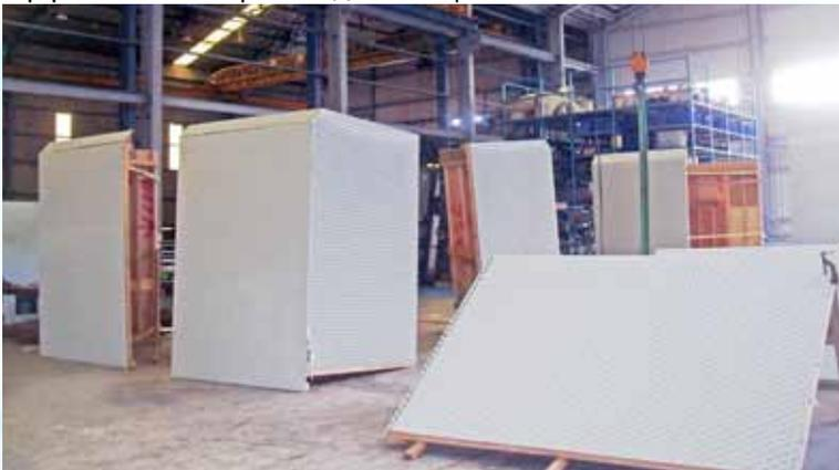
Угловые элементы заводского изготовления для ремонта резервуара.
