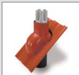
MSD 85 mit fünf Stutzen und fünf Thermo-Schrumpfmuffen Geeignet für fünf Kabel mit Durchmesser 7–18 mm. Als Zubehör sind verschiedene Aufteilkappen AK oder Verschluss-Stopfen VS 20 lieferbar.
