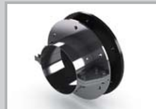
Vorbaufansch geteilt Zur nachträglichen Abdichtung vor einer Kernbohrung in einer Wand oder Decke. Wird mit EPDM-Flanschdichtung und Befestigungselementen geliefert. Ausführung in Edelstahl.
