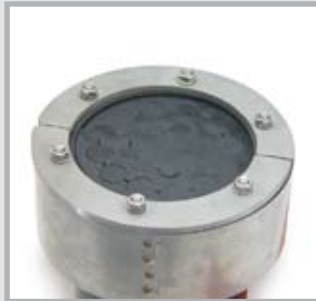
MSD 110 mit GPD Inklusive geteilter Gummi-Press-Dichtung mit Wechseleinsatz Ø 110 mm. Für maximal zwölf Kabel 1/2" und sechs Kabel RG8.
