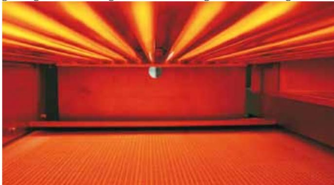
Infrarottrocknung der aufgetragenen Polymerdispersion im textilen Flächenbildungsprozess
