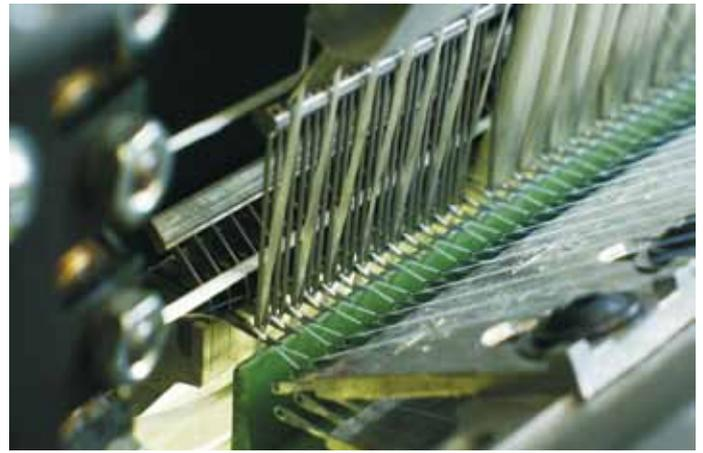
Maschengerechter Verstärkungfadeneintrag an einer Nähwirkmaschine Malimo 14022
