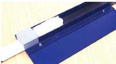
Система нанесения равномерного слоя адгезива на поверхность ламели
