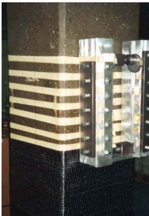
Колонна, усиленная преднапряженными арамидными лентами, для лабораторных испытаний
